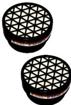
Lot de 2 filtres A2P3 S'adaptent facilement sur le demi-masque respiratoire grâce à un pas de vis Ces filtres s'utilisent uniquement avec le demi-masque respiratoire Contre les gaz et vapeurs organiques dont le point d'ébullition est supérieur à 65°C et les particules et poussières Ne protège pas contre les produits comme l'ammoniac, le chlore, les acides NORME EN14387:2004/A1:2008
